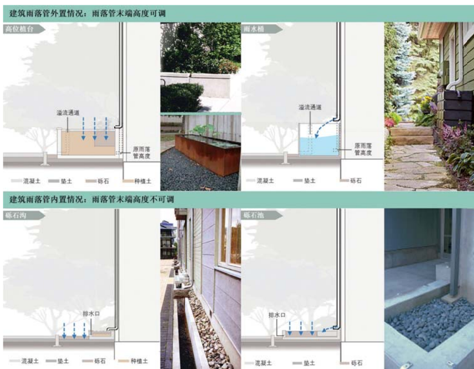
图 9 基于源头管理思想的建筑散水改造模式
